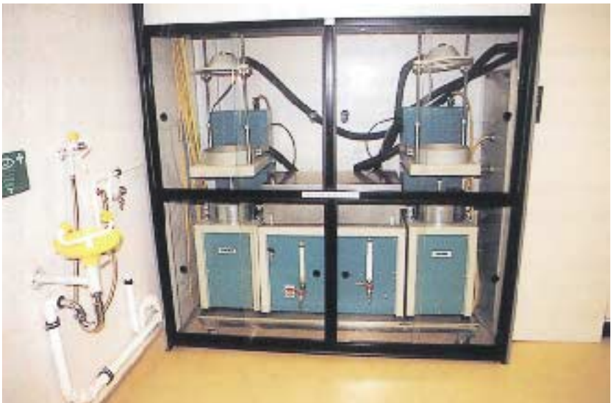
Abb. 3: Extraktionsanlage für Bitumen in einem Baustofflabor
