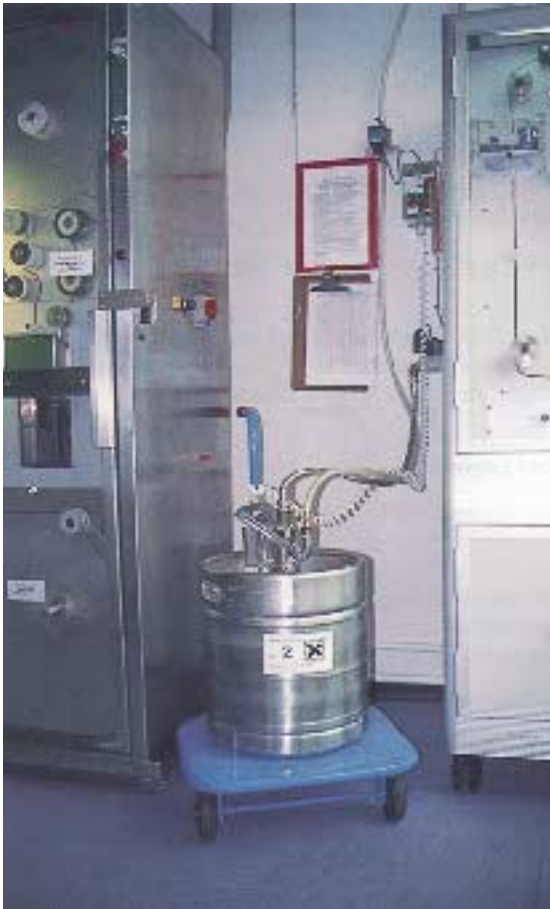
Abb. 4: Befüllung eines Vorratsbehälters mit Perchlorethen für den inner- betrieblichen Gebrauch
