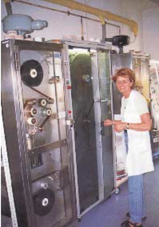
Abb. 1: Reinigung von Filmen mit Perchlorethen
