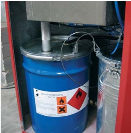
Abb. 10: Geerdetes Fass in einem Reinigungsgerät
