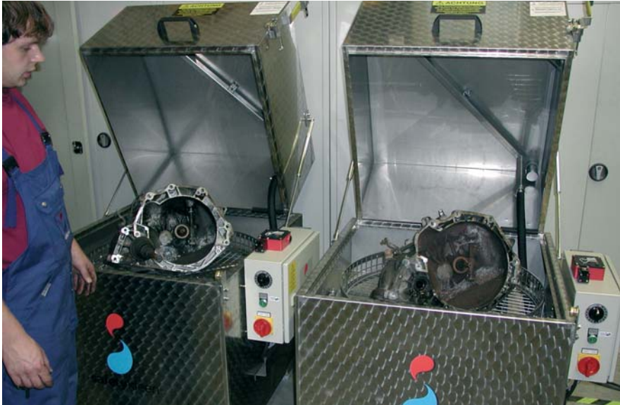
Abb. 3: Geschlossene Reinigungsanlage nach Beladung
