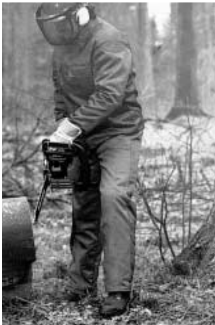
Abb. 15: Beispiel einer Schnittschutzhose nach DIN EN 381-5
