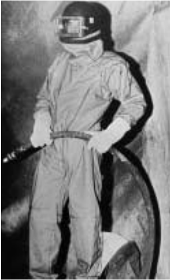
Abb. 6: Strahlerschutzanzug mit Atemschutz
