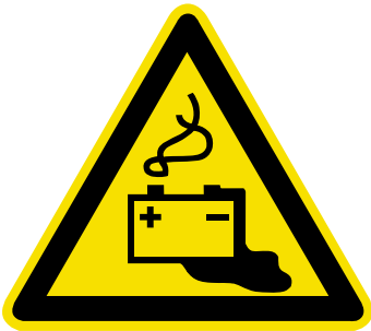
W20 Warnung vor Gefahren durch Batterien
